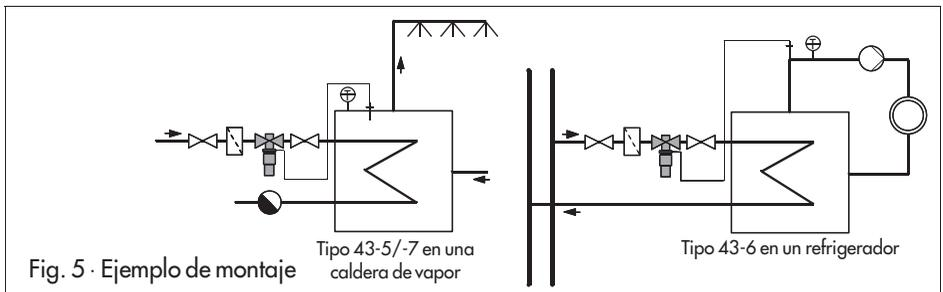
**Atención:** para evitar daños por corrosión, de deben utilizar materiales del mismo tipo en el montaje del sensor o de una vaina. Es decir, en un intercambiador de calor de acero inoxidable se debe evitar montar un sensor de temperatura o una vaina de metal no ferroso. En este caso se debe prever para el sensor una vaina de acero inoxidable.
