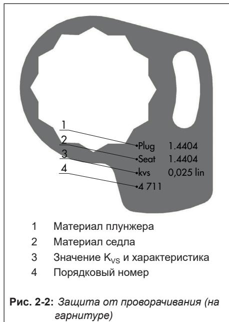
Рис. 2-2: Защита от проворачивания (на гарнитуре)
