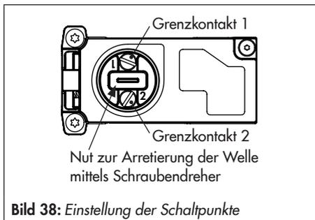
1. Ventil in Schaltposition fahren.
